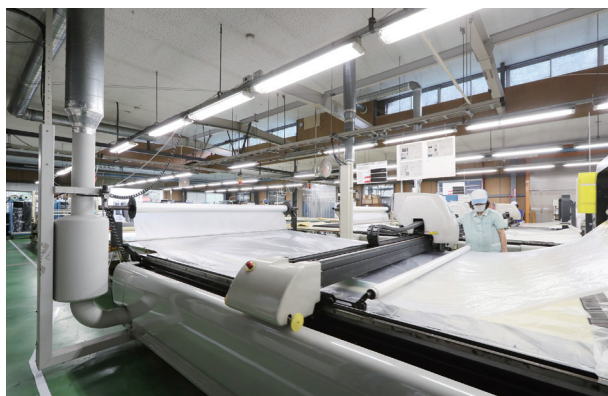
1枚の巨大なシートを専用の機械で裁断。 いかに無駄なく利用するかがポイント
